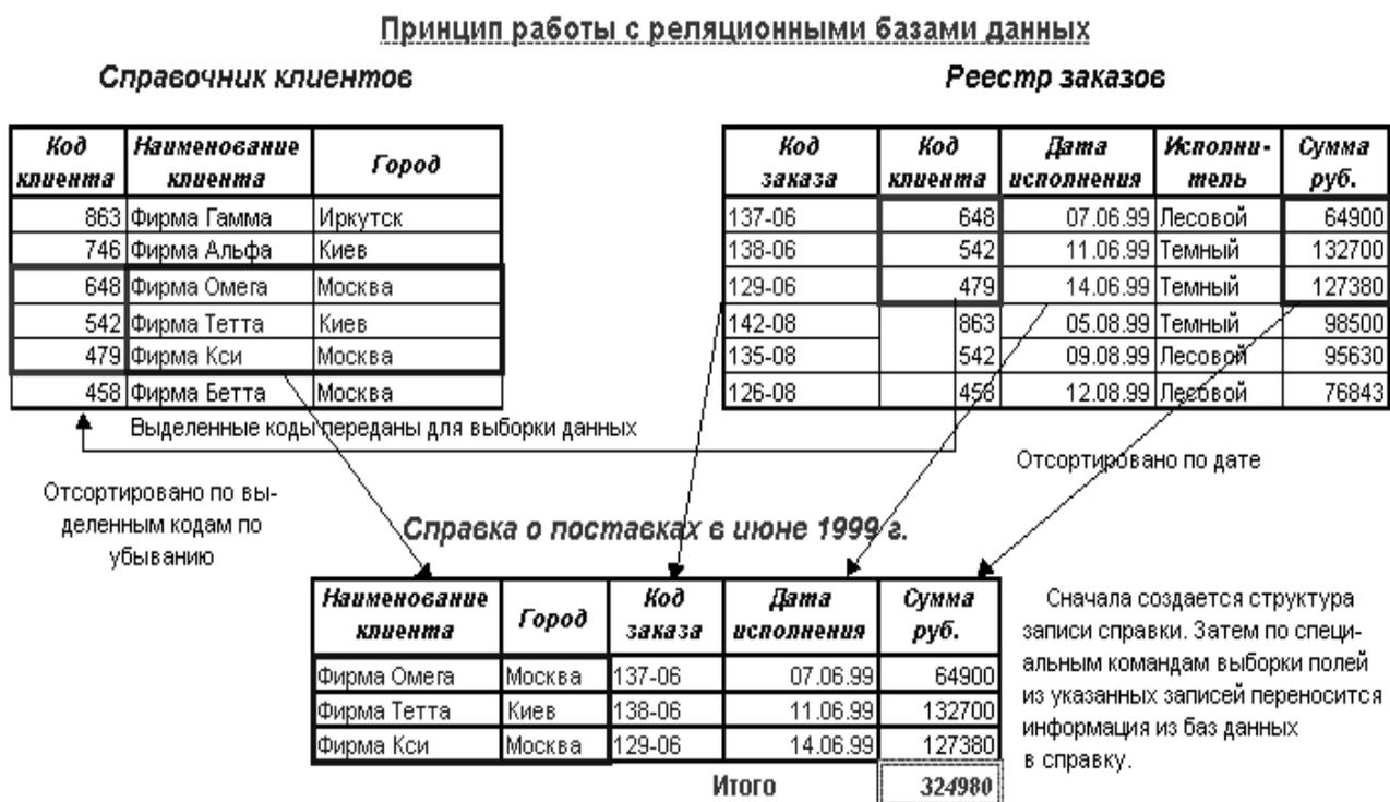
**Рис. 26. Фрагмент реляционной базы данных**
